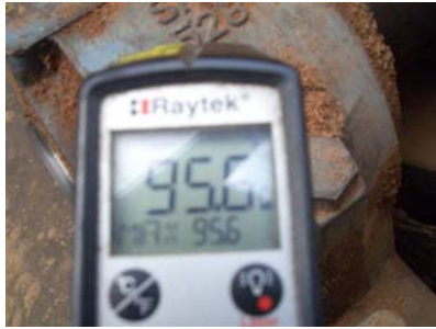
อุณหภูมิที่วัดขณะใช้จารบี EP2 ทั่วไป 24/03/2006
